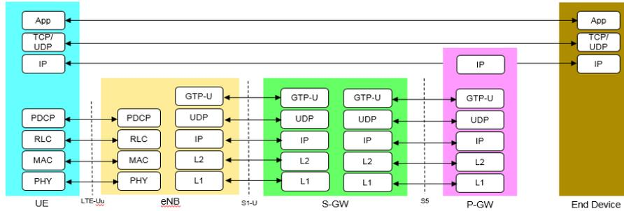
Fig. 4. 3GPP User-Plane Protocol Stack
