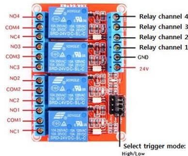
Fig. 5. Relay Module
