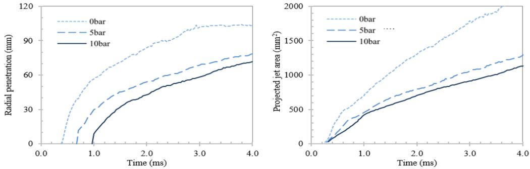
Figure 4. CNG Impingement-jet Radial Penetration & Impingement-jet Area
