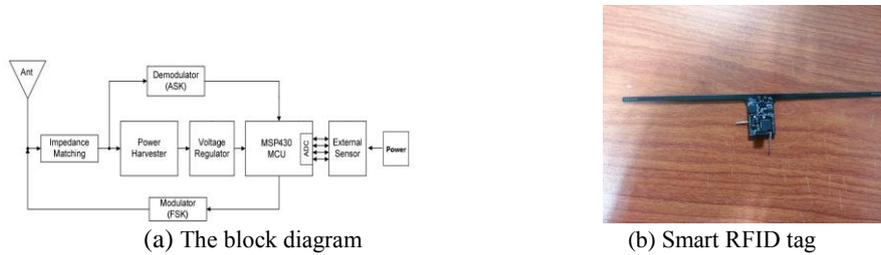
**Fig. 1** Smart RFID Tag
