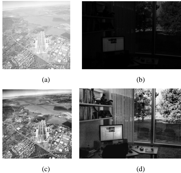
Fig. 2. Input images: (a) Aerial image(764x768) (b) Office image(903x600) Output images: (c) CLAHE(CL=0.014, BS=2x2) (d) CLAHE(CL=0.048, BS=4x4)
