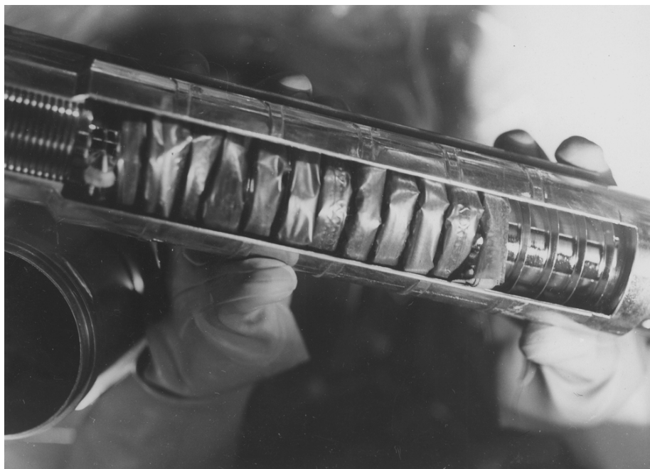
Рис. 5. Грунтонос станции “Луна-24” в транспортном положении в приемной камере в руках оператора.
